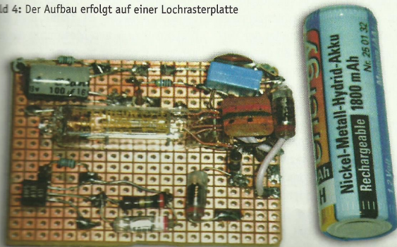
Bild 4: Der Aufbau erfolgt auf einer Lochrasterplatte
