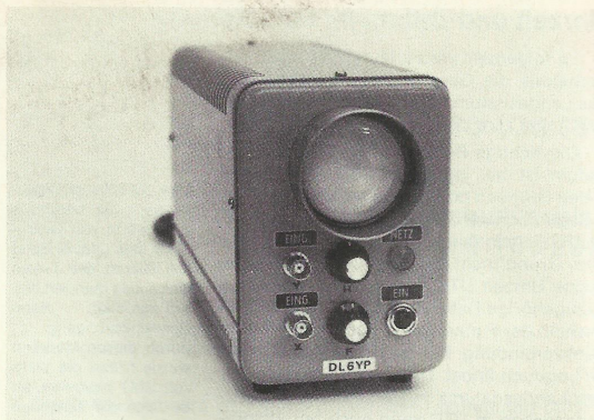
Abb. 1. Frontansicht des Abstimmoszilloskops; Foto DF4PR
